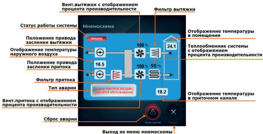
Режим просмотра мнемосхемы представляет собой экран с отображением работы системы в режиме реального времени. Ниже пример мнемосхемы приточно-вытяжной системы с электрическим нагревателем.
